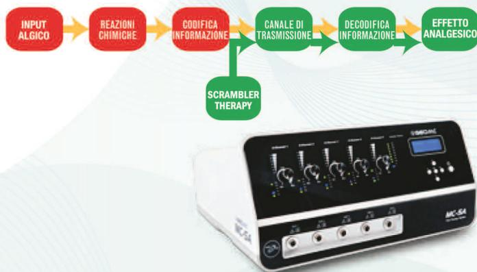
Il dispositivo medico **MC-5A per la Scrambler Therapy** simula 5 neuroni artificiali che, tramite elettrodi in superficie applicati sulla pelle, vengono utilizzati per modulare impulsi elettrici di bassissima intensità in grado di inviare dei segnali che vengono identificati dal sistema nervoso centrale come segnali di “non dolore”.
